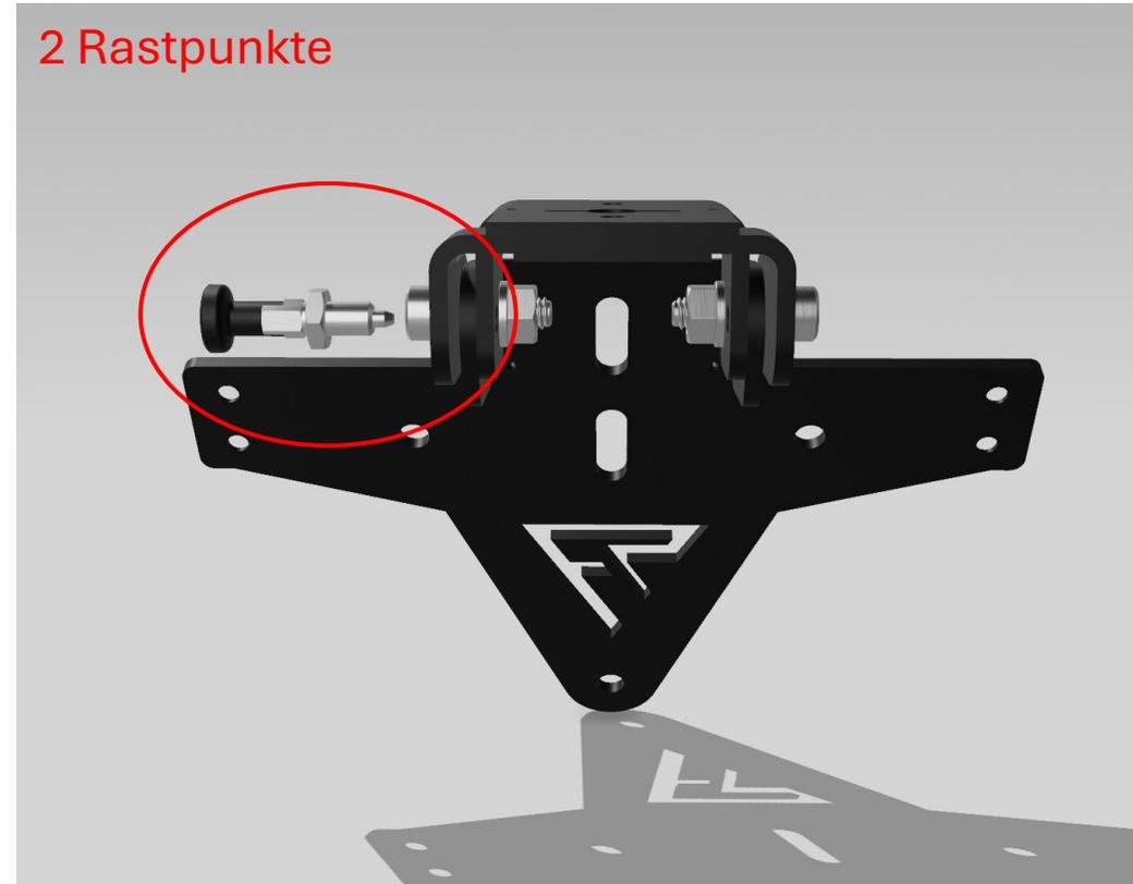
Den Rastbolzen entweder auf der rechten Seite für einen Rastpunkt oder auf der anderen Seite für zwei Rastpunkte montieren.
