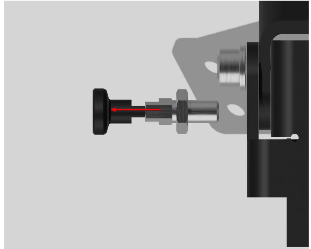
Den Rastbolzen mit etwas mittelfestem Loctite in das Gewinde drehen und vorher vorspannen.
