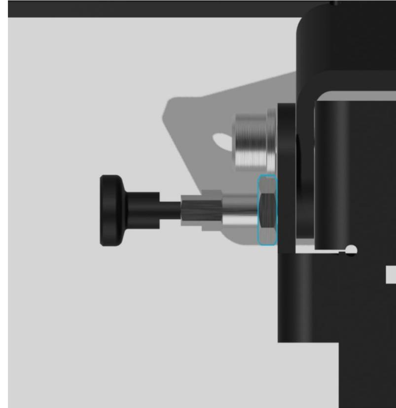
**Wichtig:** Den Bolzen nur in das äußerste Teil des Halters schrauben und mit der Mutter handfest sichern!
